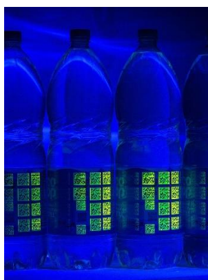
Figura 2. Etiquetas UV que se adhieren a los envases de plástico.
