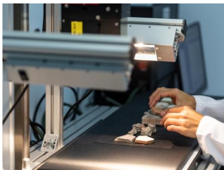
Figura 1. Uso de imágenes hiperespectrales para la clasificación automática de residuos de construcción y demolición.
